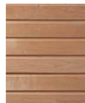
Tervaleppäpaneeli ja laudelauta 15x90 STP. Pontin reunamuoto pyöristetty. Lauteet: tervaleppä
